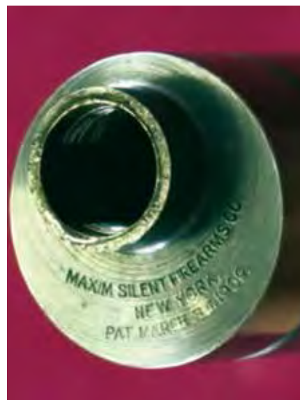
Figure 8b Marquages apposés sur un silencieux Maxim, qui permettent d'identifier le nom du fabricant, le lieu de fabrication et la date du brevet. Source : Ian McCollum/ARES
