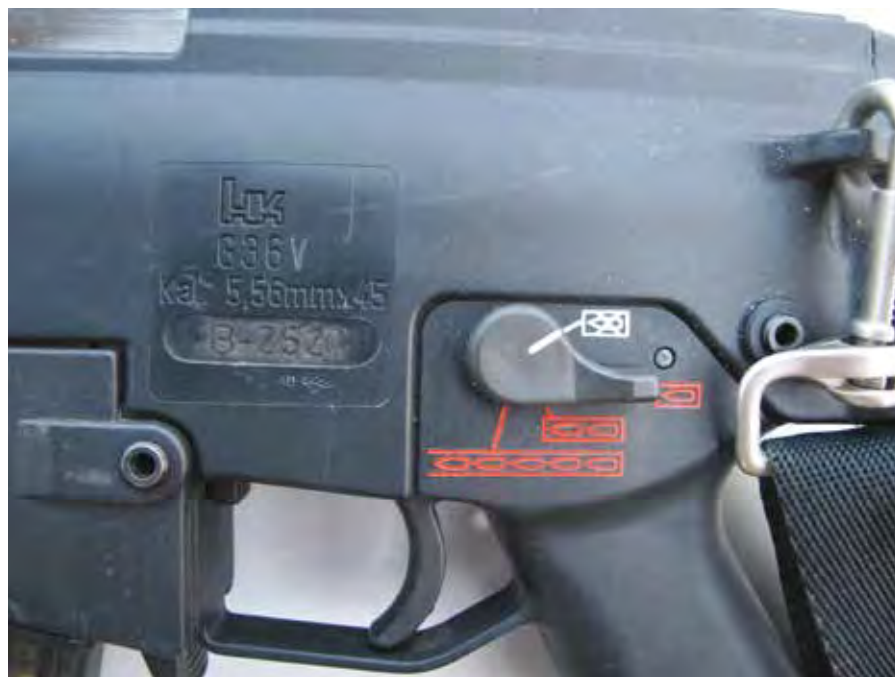
Figure 3c Marquages présents sur un fusil d'assaut allemand Heckler & Koch de type G36. On peut identifier le fabricant, la désignation du modèle, le calibre et les marquages du sélecteur de tir (de type pictographique). Ce qui semble être un numéro de série (« B-252 ») a été gravé sur une zone abrasée qui portait le numéro de série apposé en usine. Source : Damien Spleeters
