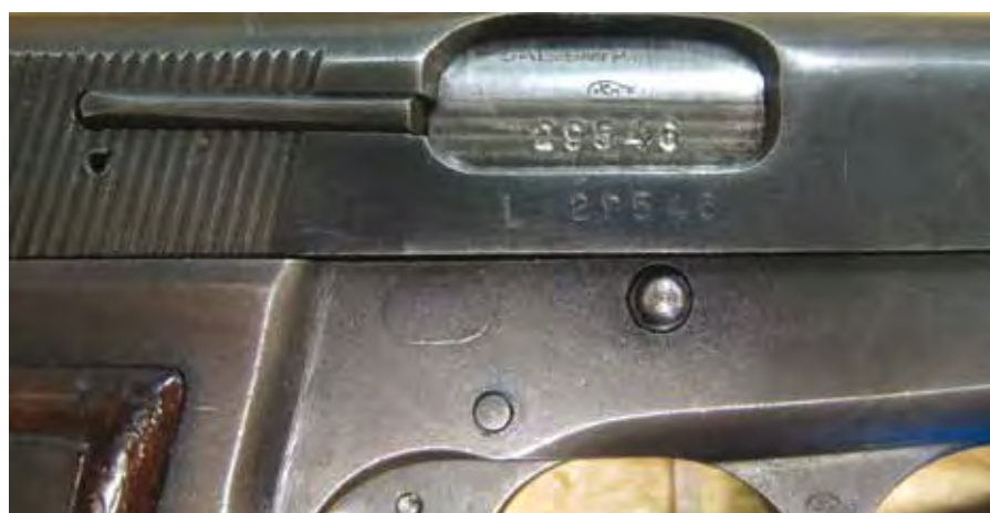
Figure 3b Marquages présents sur un pistolet belge GP35, produit par FN Herstal. On peut voir le numéro de série (dans deux endroits), le calibre et les marquages du banc d'épreuve. Source : N.R. Jenzen-Jones/ARES. Source : N.R. Jenzen-Jones/ARES
