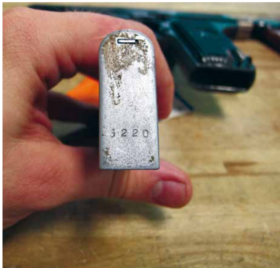
Figure 5b Un numéro de série partiel frappé au talon du chargeur d'un TTC 7.62 x 25 mm roumain. Source : N.R. Jenzen-Jones/ARES
