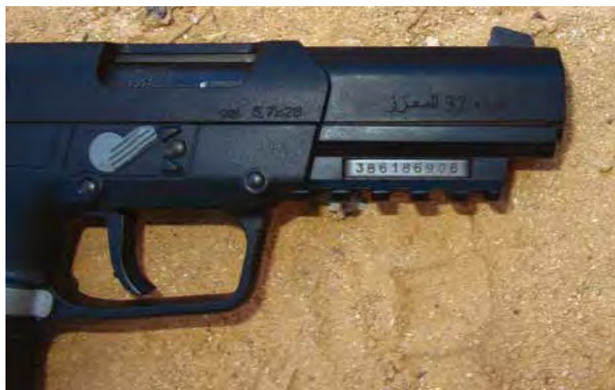
Figure 3e Marquages présents sur un pistolet semi-automatique belge FN Herstal Five-seven. On peut identifier les marquages relatifs au calibre (dans deux endroits) et le numéro de série ainsi que des marquages propres au client probablement apposés au moment de la fabrication. Dans ce cas précis, le texte en arabe signifie « 32e brigade renforcée » et se réfère à l'unité de l'armée libyenne pour laquelle ces armes ont été achetées. Source : Damien Spleeters
