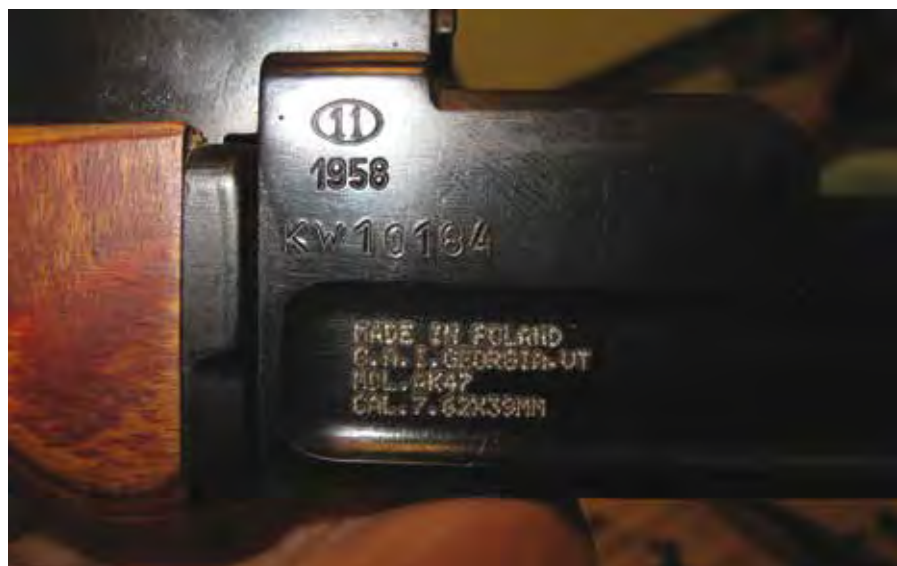
Figure 3d Marquages d'importation (pays d'origine, entité importatrice, modèle et calibre) apposés sur un fusil semi-automatique polonais Kbk AKM importé aux États-Unis. On peut aussi observer les marquages permettant d'identifier l'usine, l'année de production et le numéro de série. Il est à noter que les marquages d'importation identifient à tort cette arme comme un « AK-47 ». Source : N.R. Jenzen-Jones/ARES
