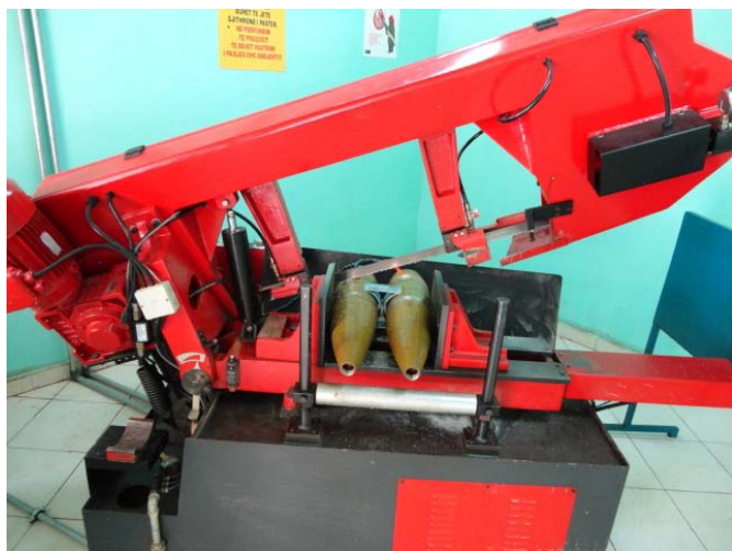
Visokoeksplzivni projektili se obrađuju pomoću industrijske trakaste testere (levo) i otvorene čaure kao proizvod obrade se transportuju radi uklanjanja energetskog materijala (desno). © NAMSA
