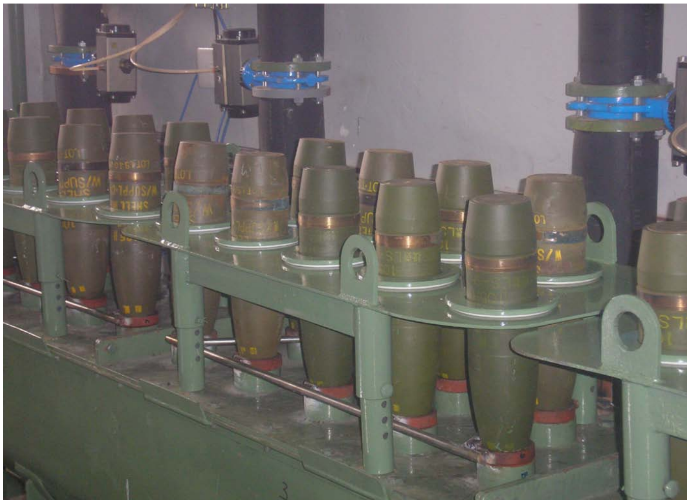
Разснарядване на снаряди, заредени с TNT. © „Експал България“
