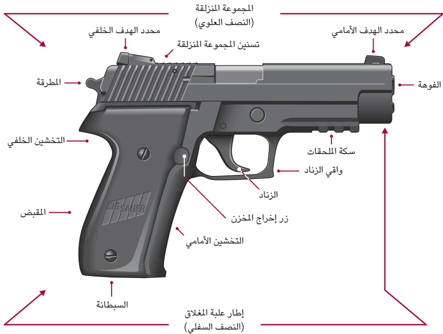
الشكل 3-2: السمات النموذجية للمسدسات المحمولة الحديثة
