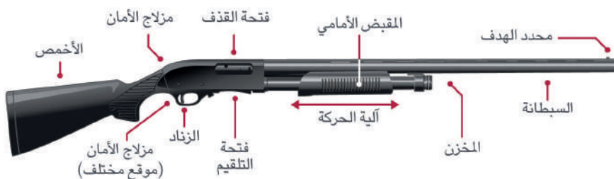
الشكل 3-8: السمات النموذجية لبندقية رشاشة بآلية إطلاق منزلق
