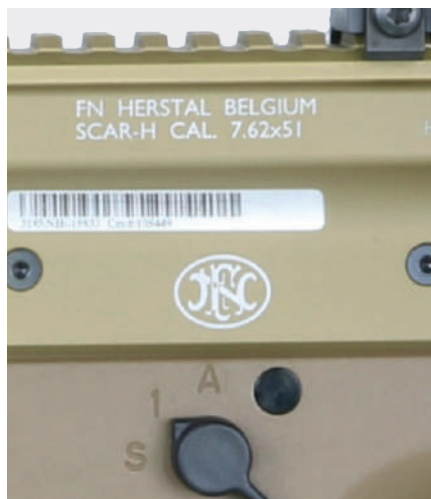
الصورة 3-43: أوسام الإصدار والمانع على بندقية بلجيكية ذاتية التقييم من طراز SCAR-H من تصنيع FN Herstal
