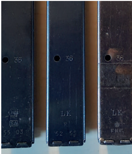
ملاحظة: تظهر هذه المخازن اختلاف تقنيات الإنشاء والتشطيبات المعدنية والخطوط المستخدمة لوسم الرقم "36" المصدر: N.R. Jenzen-Jones/ARES
