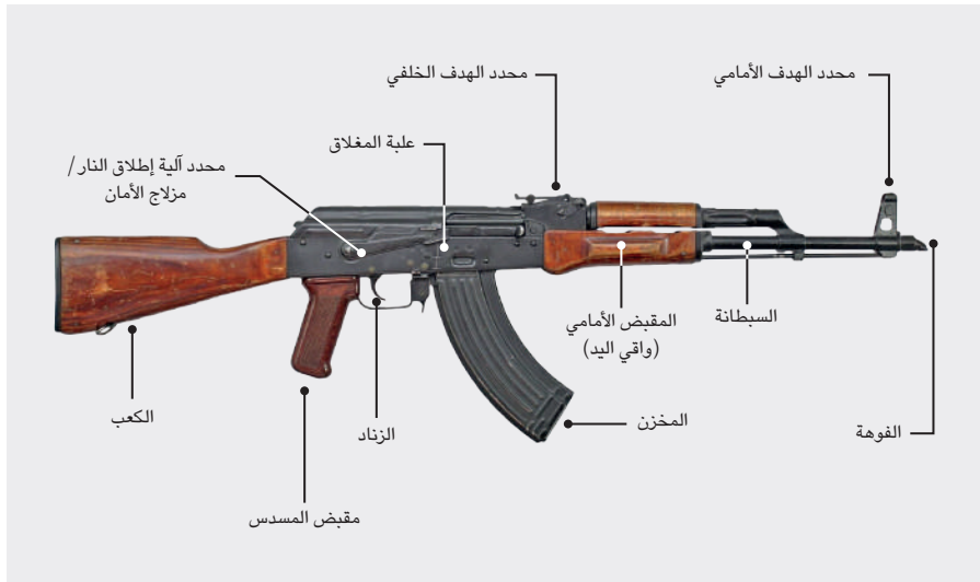
الشكل 3-9: السمات النموذجية لبندقية عسكرية حديثة
