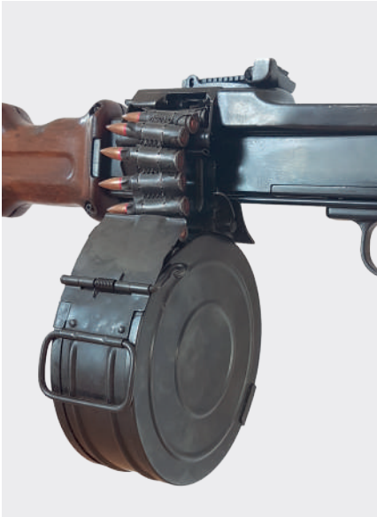
الصورة 3-27: حزام غير قابل للفصل لخراطيش من عيار 39×7.62 ملم موجود في حاوية أسطوانية خارجية لرشاش ديغتياروف الخفيف
