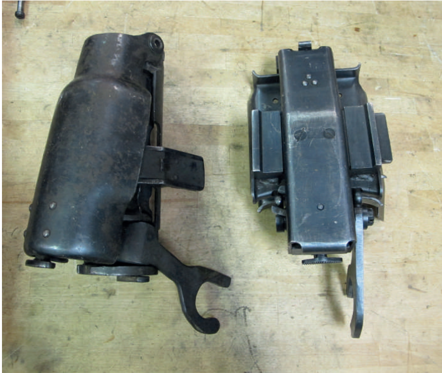
الصورة 3-30: آليات تلقيم الحزام لرشاش DShK ثقيل (يسار) ورشاش DShKM ثقيل (يمين)
