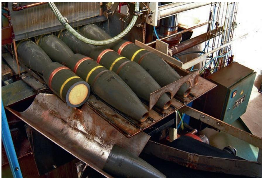
Le découpage à la scie de projectiles hautement explosifs expose leur contenu énergétique. Les composants sont ensuite acheminés sur un convoyeur à courroie vers la station suivante pour y faire fondre les matières explosives. Lübben, Allemagne, 2012. Source : Spreewerk Lübben GmbH
