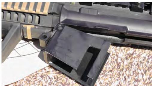
Image 4. La conversion du calibre 7,62 × 51 au 5,56 × 45 est effectuée grâce à l'installation rapide d'un adaptateur de magasin.
