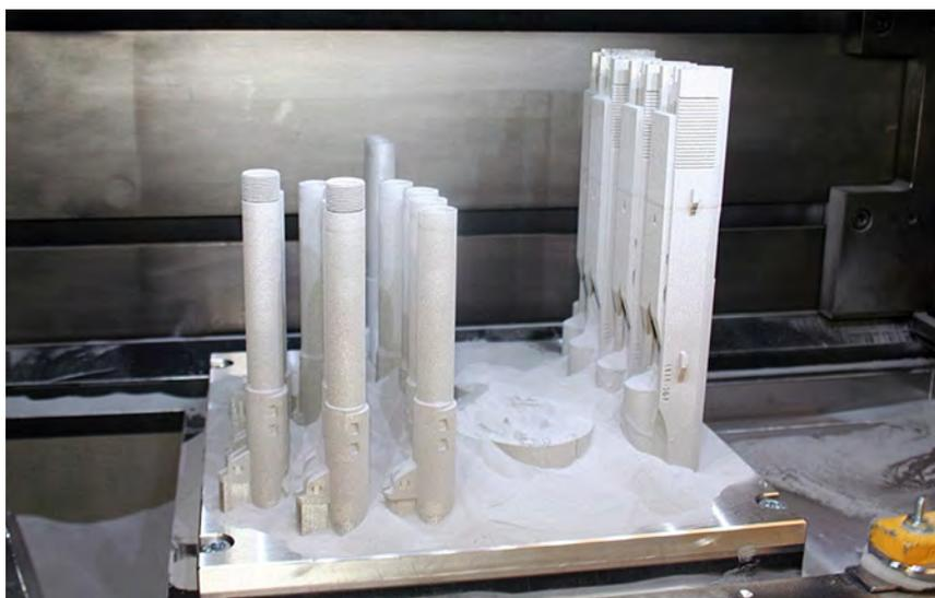
Image 1. **Quelques composants (canon et bloc glissière) de pistolet Solid Concepts 1911 DMLS produits par une imprimante 3D DMLS.** © Solid Concepts, Inc.
