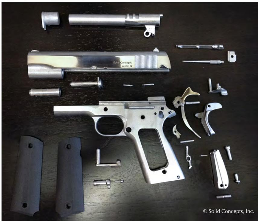
Image 3. Les pièces d'un pistolet 1911 DMLS de Solid Concepts, produites par DMLS.
