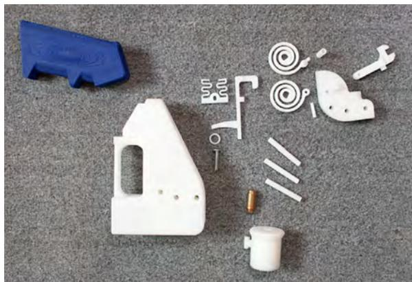
Image 2. **Un pistolet Liberator de Defense Distributed démonté pour montrer ses différentes pièces. On peut voir le percuteur métallique (clou).**
