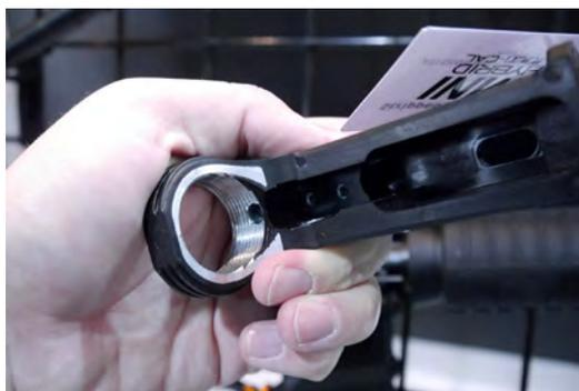
Image 7. Cette partie inférieure de boîte de culasse de marque Some est dotée d'un petit insert métallique qui renforce la zone de jonction particulièrement fragile.
