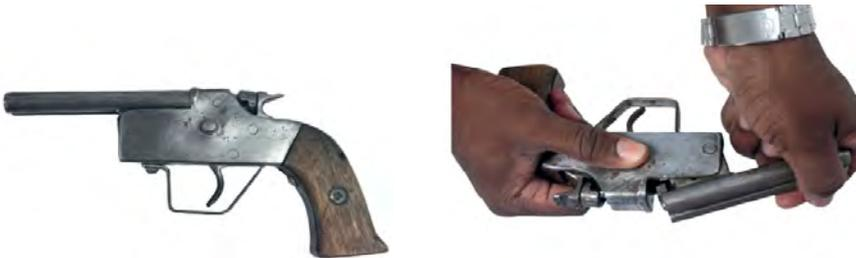
Note : le rouet semi-circulaire monté sur le marteau pivote pour permettre à l’utilisateur de tirer avec l’un ou l’autre des canons, ou avec les deux en même temps.
