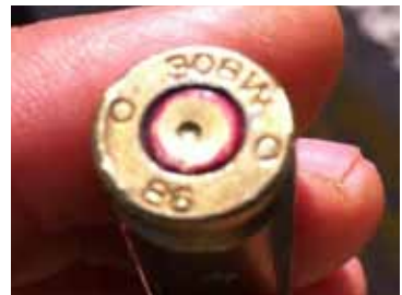
صورة ٢٦ غلاف خرطوشة نوع 308 Winchester تشيكوسلوفاكية الصنع أنتجها في عام ١٩٨٦ Sellier & Bellot © Damien Spleeters
