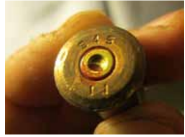
صورة ٢٢ غلاف خرطوشة صينية الصنع من عيار 7.62 x 54 R ملم أنتجها في عام ٢٠١١ مصنع الدولة ٩٤٥. © Damien Spleeters
