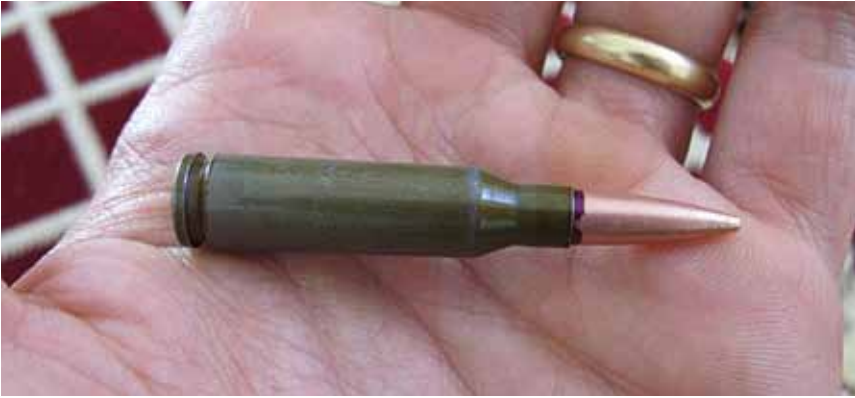
صورة ٤١ خرطوشة "FMJ" روسية الصنع من عيار 39 × 5.45 ملم أنتجها في عام ١٩٩٨ "Barnaul Machine Tool Plant". © Damien Spleeters
