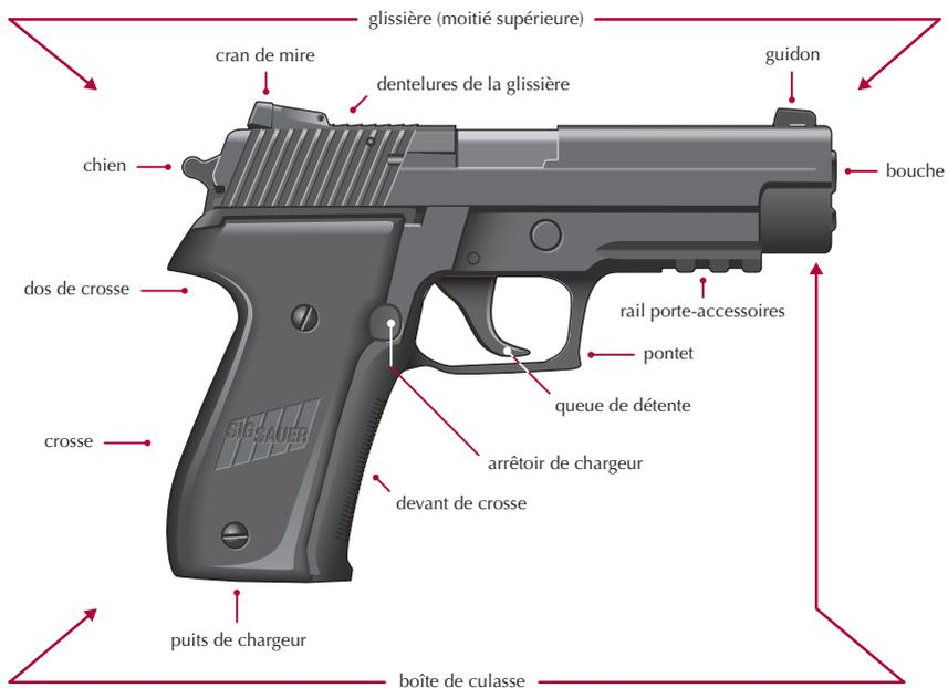
Note : ces diagrammes ont un caractère uniquement indicatif. La mise à feu de nombreux pistolets semi-automatiques est par exemple déclenchée par un percuteur et non par un chien.
