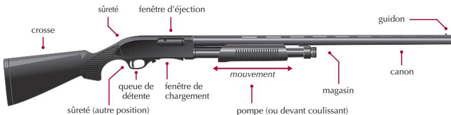
**Schéma 4** Pièces composant une arme d'épaule : l'exemple du fusil à verrou
